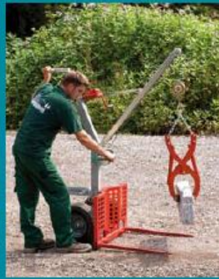
Kran und Steinzange
